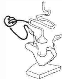
Primer transistor desarrollado en 1947 con clips, alambres, un trozo de germanio y una hoja de afeitar (Bell Telephone Labs)
